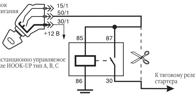
Дистанционно управляемое реле HOOK-UP тип А, В, С
