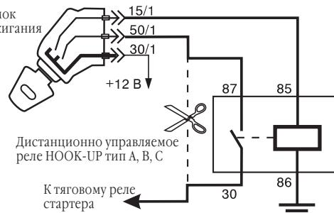
Дистанционно управляемое реле HOOK-UP тип А, В, С
