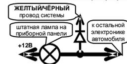
Подключение реле подхвата зажигания
