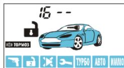
**вариант 4** - работа канала в режиме поддержки +12В на контакте IGN1 (15/1) замка зажигания при активации режима охраны с работающим двигателем. Поддержка зажигания происходит автоматически при работающем двигателе (или включенном зажигании) при затягивании ручного тормоза. Время нахождения в режиме поддержки зажигания не ограничено. Поддержка будет выключена при выключении зажигания или при отпуске ручного тормоза.
