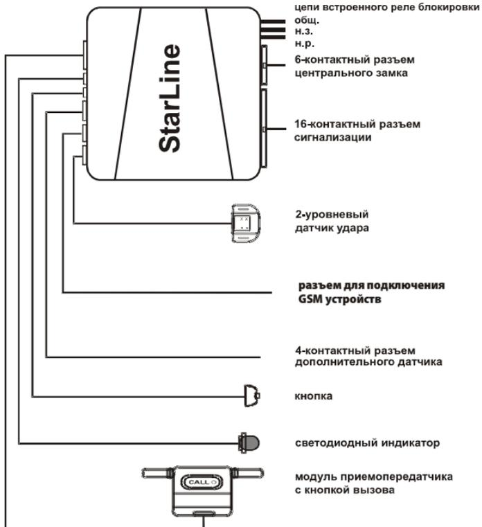
Подключение 16-контактного разъема
