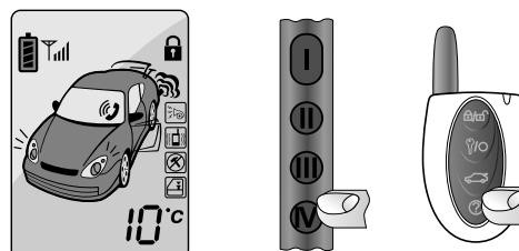
Повторное короткое нажатие кнопки IV брелока-коммуникатора в течение 6 секунд после первого позволяет посмотреть информацию о напряжении аккумулятора автомобиля в вольтах.
