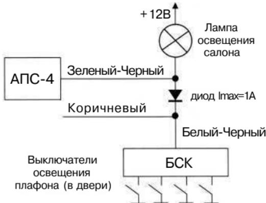
3. Рекомендуемая схема подключения ЗЕЛЕНОГО провода системы ("отрицательный триггер капота/багажника") к подкапотной лампе автомобилей ВАЗ семейства 2109, 2115, 2123 или лампе освещения багажника автомобилей ВАЗ семейства 2115:
