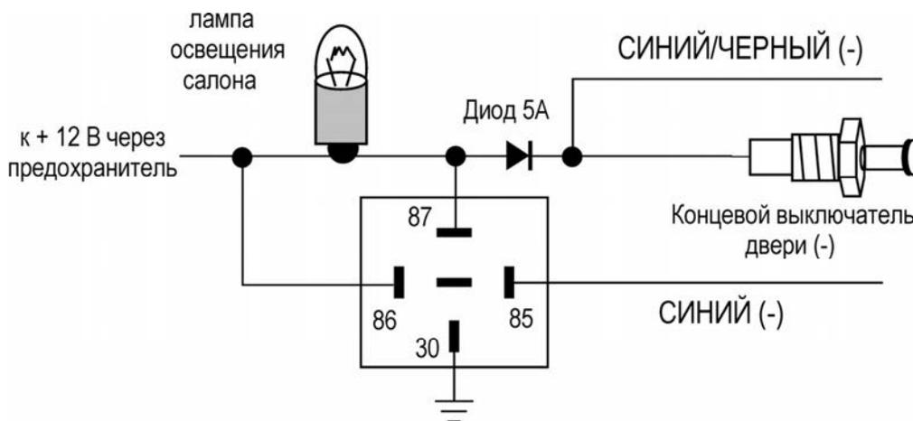
При положительных концевых выключателях дверей:
