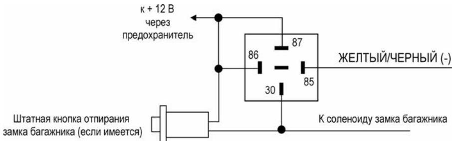
**ЖЕЛТЫЙ/КРАСНЫЙ провод:** отрицательный выход 2-го канала системы для реализации функции отпирания дверей в 2 этапа или для дистанционного управления дополнительными устройствами. Максимальный ток нагрузки 300мА, для подключения требуется дополнительное реле. Длительность импульса выходного сигнала программируется как импульсный 0,8 с, таймерный от 1 до 60 секунд (с отключением датчиков системы или без отключения датчиков) или "постоянный" ("защелка") см. программирование функции # 1.14.
