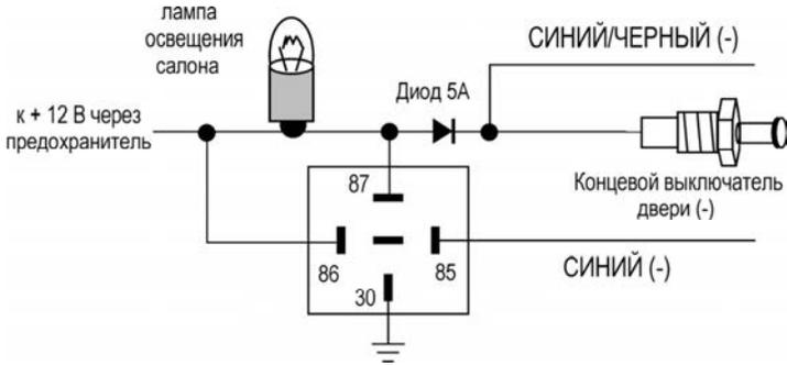
При положительных концевых выключателях дверей:
