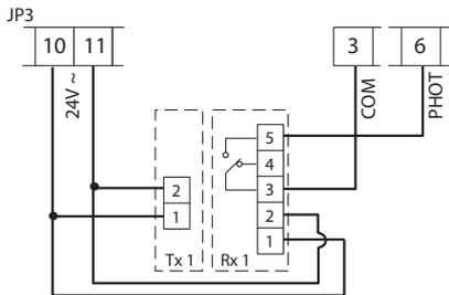
Логический тест фотоэлементов DIP TEST FHOT - OFF.
